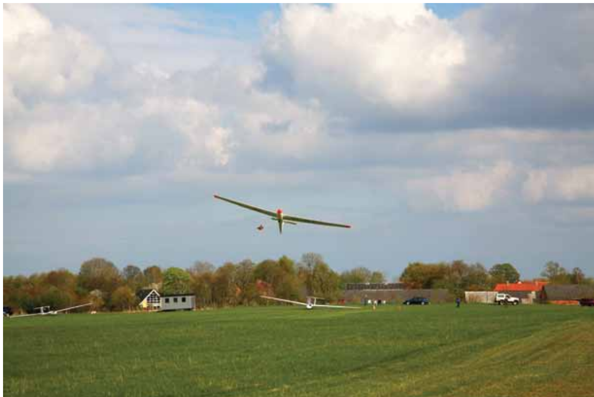
Svæveflyet trækkes op ved hjælp af en 900 m. lang wire og en kraftig motor. Foto: Martin Jensen
